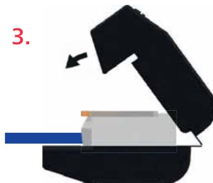
Posizionare il morsetto nell'involucro pre-riempito di gel e chiuderlo premendo fino a quando le chiusure non scattano in posizione.
